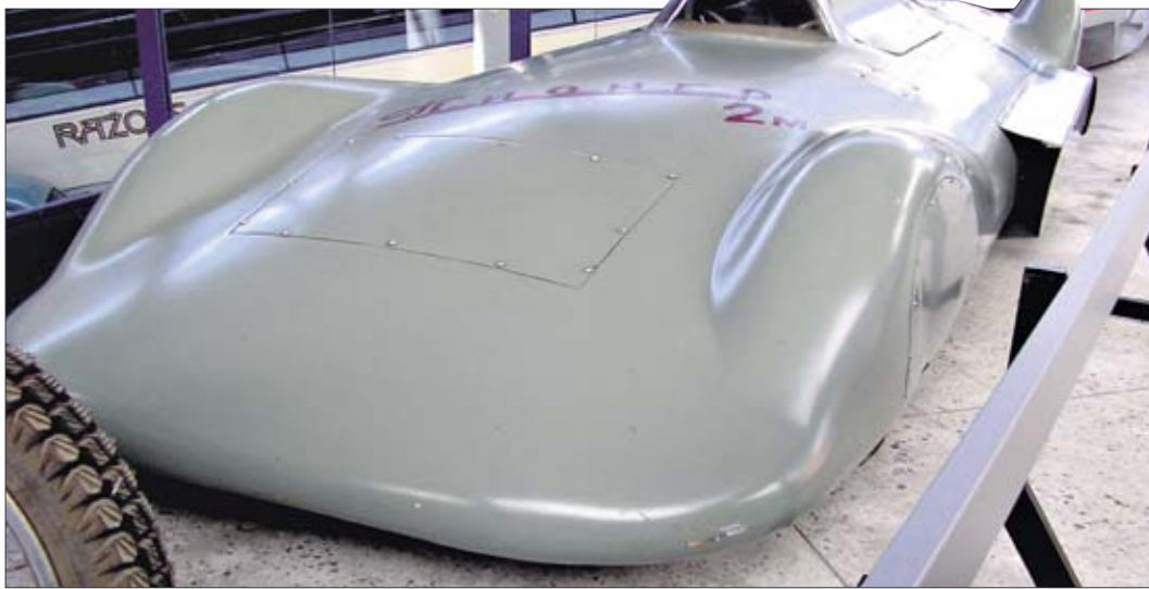
«Пионер». Советский болид разогнался до 311 км в час на газотурбинных двигателях
